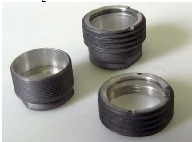
Figure 3 : Ces cellules fermées (10 mm de diamètre x 10 mm) sont utilisées lors de l'exposition en orbite d'échantillons gazeux. Elles ont été conçues et réalisées avec le financement CNES par la société COMAT Aerospace basée à Toulouse. Elles consistent en deux cylindres d'aluminium vissés l'un dans l'autre. Deux fenêtres en MgF2 ou en quartz sont collées à chacune des extrémités. Ce concept rend possible à la fois la photolyse et l'analyse par spectroscopie au travers de la cellule. Une première génération de cellules a été utilisée pour les expériences UVolution et PROCESS. En 2008, pour l'expérience AMINO, elles ont été remplacées par de nouvelles cellules développées par la société Air Liquide, cellules dont l'étanchéité est compatible avec des durées d'exposition de plusieurs années.
