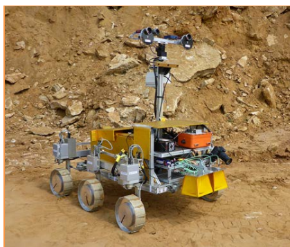
Figure 7 : Modèle de rover d'ExoMars en test dans le désert d'Atacama (Chili), portant les instruments CLUPI, WISDOM et PANCAM
